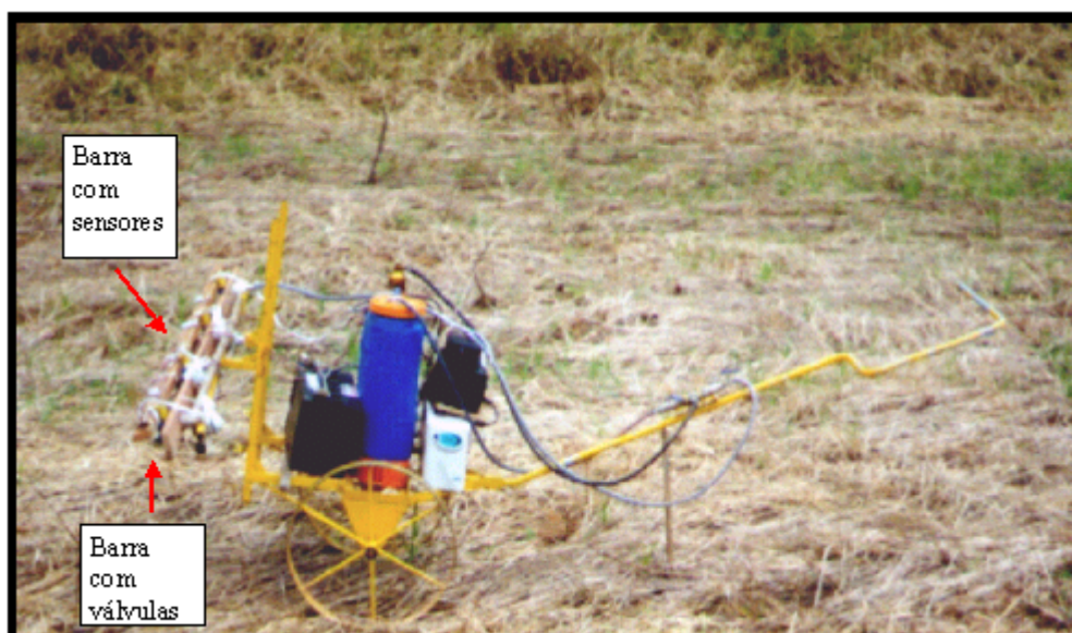
Figura 13 - Pulverizador de tração humana na área de teste.
