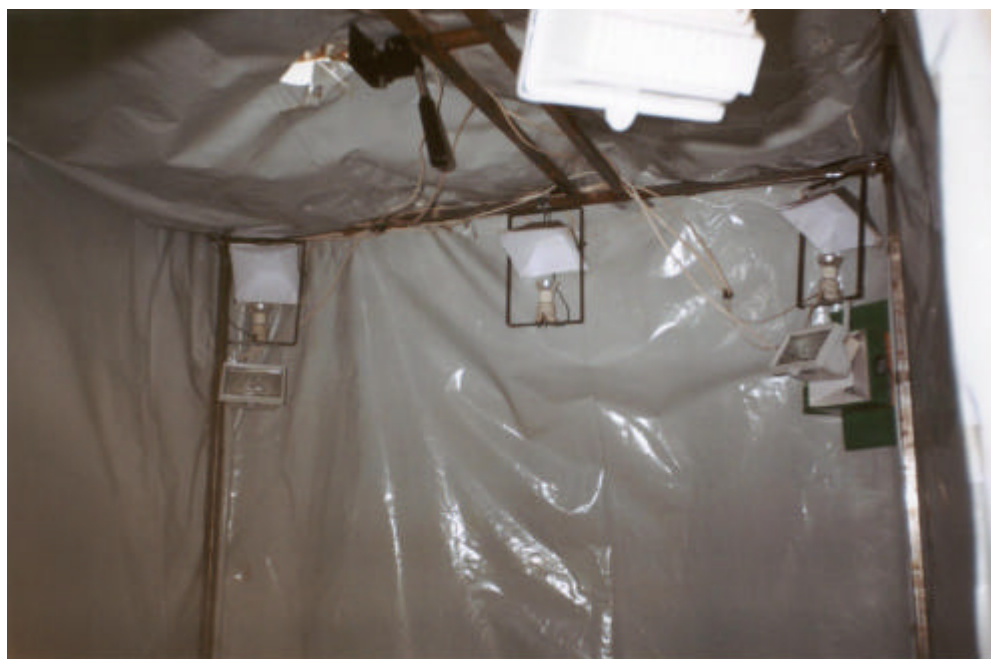
Figura 5 – Sistema de iluminação montado para a coleta das imagens.
