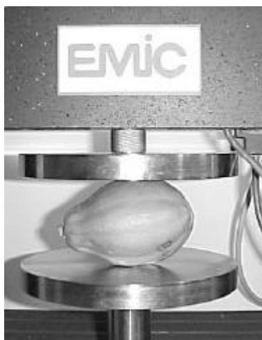
Figura 6 - Placas planas e paralelas da máquina EMIC utilizadas para realização dos ensaios de compressão.
