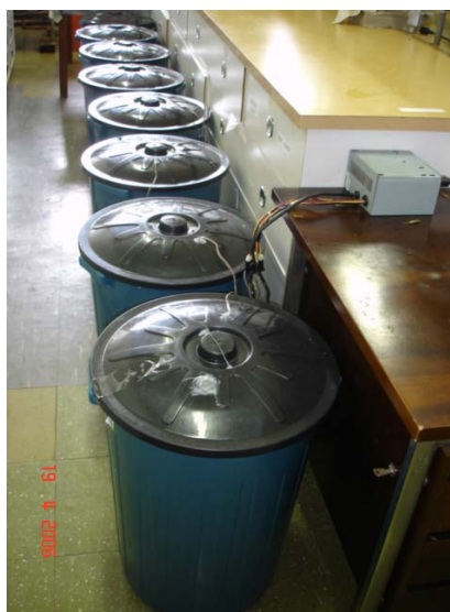
Figura 1 - Câmaras de 60 L nas quais as plantas foram tratadas com etileno.
