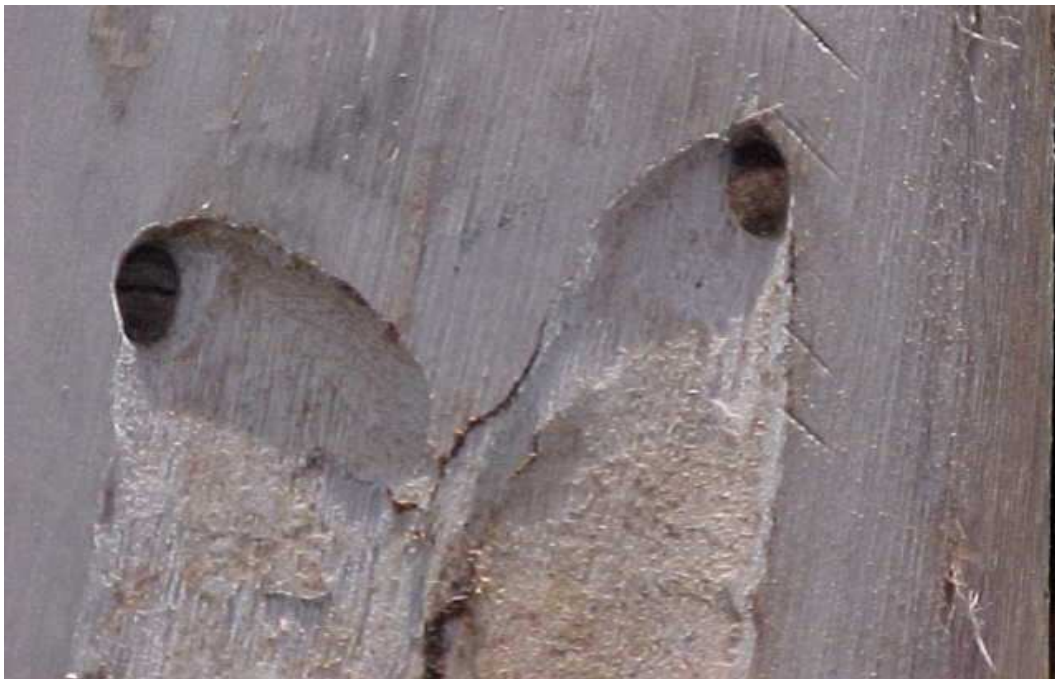
Figura 4 - Larva intralenhosa de Phoracantha semipunctata (Coleoptera: Cerambycidae), com dano característico à madeira.
