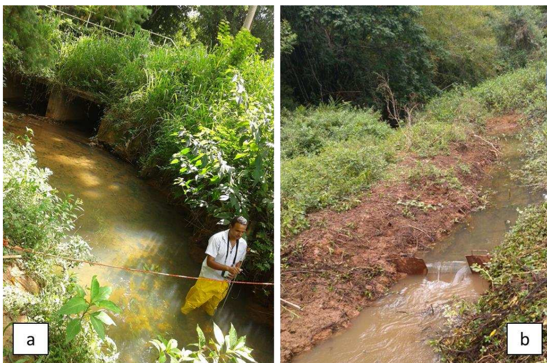
Figura 3 – Campanhas de medição de vazão: (a) molinete fluviométrico; e (b) vertedor retangular.
