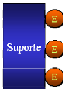
Figura 1: Representação esquemática da ligação de uma enzima a um suporte por adsorção.
