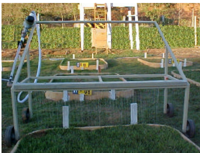
Figura 5 - Vista do dispositivo usado para aplicação de água nos lisímetros.
