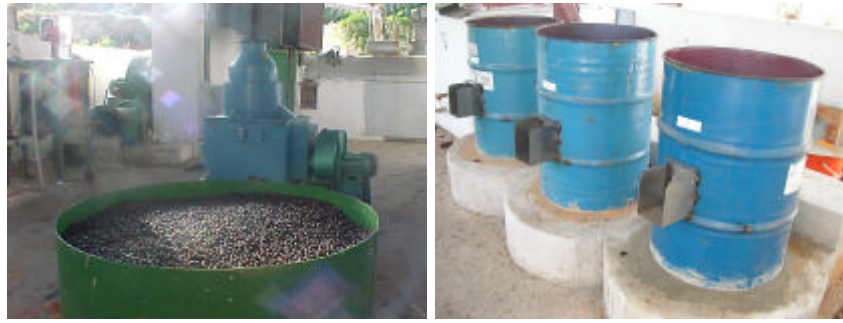
Figura 01: (a) secador de camada fixa, câmara única; Câmaras de secagem do secador tipo tambor, de camada fixa.
